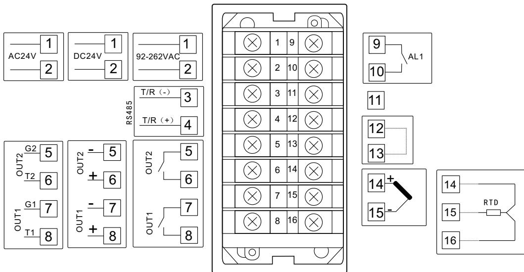
5. 4. AL808M电气接线图 (72×72mm)
