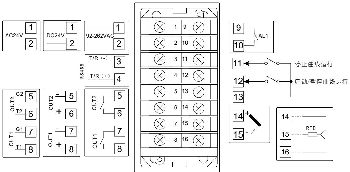
5. 4. AL808M电气接线图 (72×72mm)
