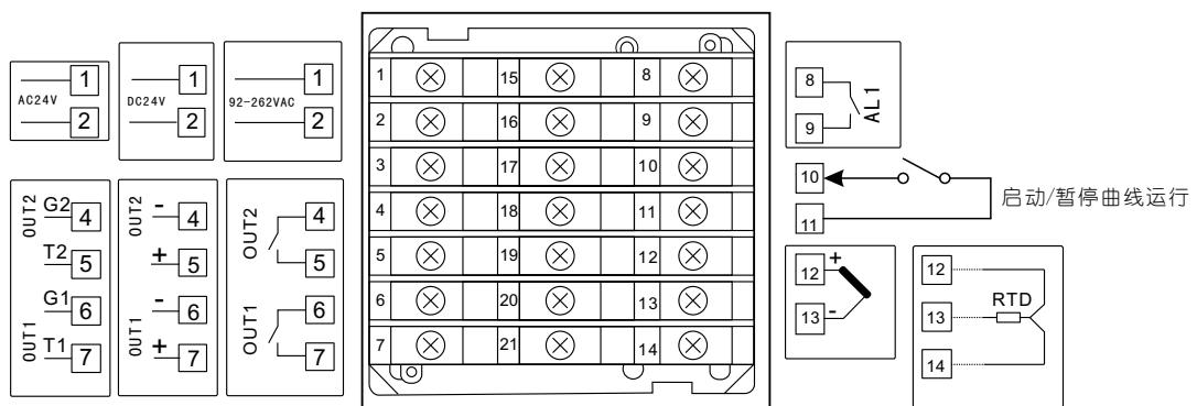
5. 5. AL808A, AL808B电气接线图 (160×80mm, 80×160mm)
