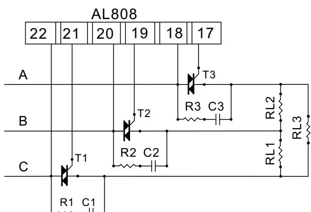
备注:星形接法的零线可连接也可不连接
