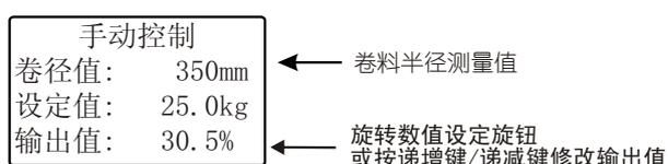
当从手动控制切换到自动控制时,控制器将保存此时的张力值。
