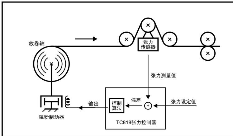
控制器比较张力设定值和张力测量值的偏差,经比例积分算法计算后,调节输出,使卷料张力趋于设定值,达到恒张力控制的目的。因此,设置适当的比例,积分,静区参数值对张力系统的稳定性很重要。
