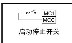
进行自动控制时,请将MC1开关接通。
