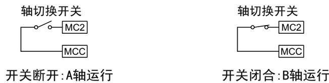
TC818张力控制器的轴切换功能由接线端子MC2, MCC控制, 在MC2, MCC端子接一开关, 此开关即为系统的轴切换开关。当轴切换开关断开时, A轴运行;当轴切换开关短接时, B轴运行。
