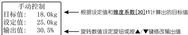
当从手动控制切换到自动控制时,控制器将保存此时的张力值。
