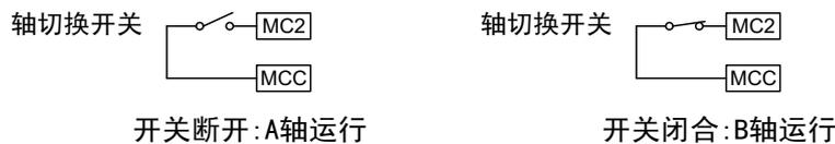
TC818张力控制器的轴切换功能由接线端子MC2, MCC控制, 在MC2, MCC端子接一开关, 此开关即为系统的轴切换开关。当轴切换开关断开时, A轴运行; 当轴切换开关短接时, B轴运行。
