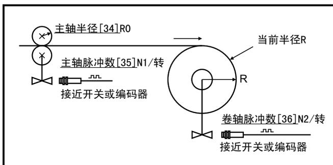
当采用比值法测量卷径时, 控制器对卷轴及主轴接近开关产生的脉冲进行计数, 并根据所设参数自动计算出卷径值, 比值法不需要设定卷料厚度[02], 卷取方式[39]。
