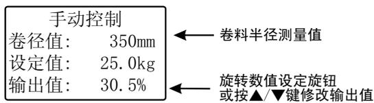
当从手动控制切换到自动控制时, 控制器将保存此时的张力值。
