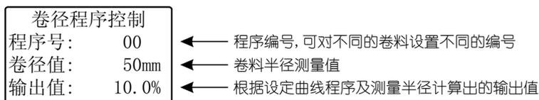
TC818按照实测卷径及设置的卷径-输出值曲线经运算后调节输出,达到张力控制的目的。
