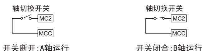
TC818张力控制器的轴切换功能由接线端子MC2, MCC控制, 在MC2, MCC端子接一开关, 此开关即为系统的轴切换开关。当轴切换开关断开时, A轴运行; 当轴切换开关短接时, B轴运行。
