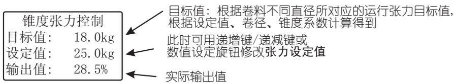
提示: 当kg/N指示灯亮时, LED显示窗可以显示测量值
