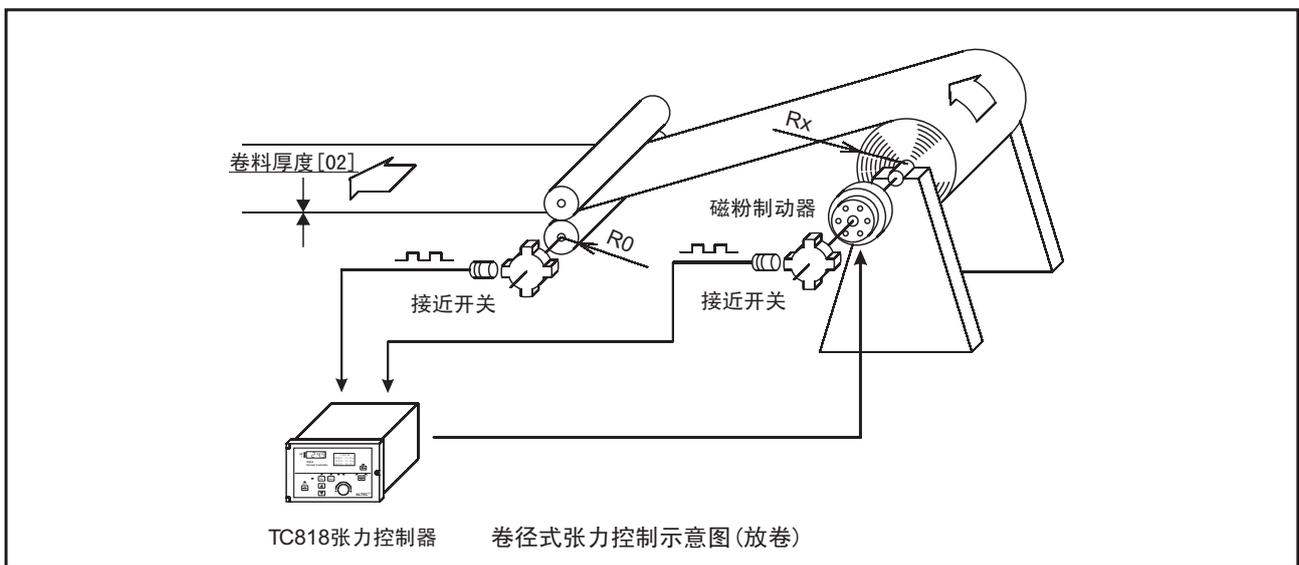
必须保证卷径测量计算准确,因此与卷径测量计算相关的参数必须正确设置,而且要特别注意测量卷径的接近开关或编码器的响应速度及正确安装。
