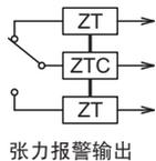
当报警输出[44]设为上限报警输出, 如张力测量值大于设定的张力报警值[04], 张力报警继电器将会吸合, 同时面板上的张力报警指示灯ALM会点亮。
