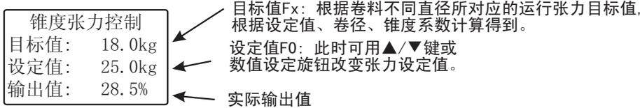
提示:当kg/N指示灯亮时,LED显示窗可以显示测量值
