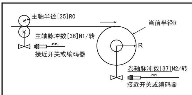
当采用比值法测量卷径时, 控制器对卷轴及主轴接近开关产生的脉冲进行计数, 并根据所设参数自动计算出卷径值, 比值法不需要设定卷料厚度[02], 卷取方式[40]。
