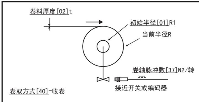
控制器对卷轴接近开关产生的脉冲进行计数, 根据累计数N和初始半径[01]R1, 按下式计算当前的卷径:
