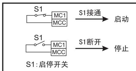
TC818张力控制器的启动、停止由接线端子MC1, MCC控制, 在MC1, MCC端子接一开关, 此开关(S1)即为系统的启停开关, S1开关的接通或断开将启动或停止张力系统运行。
