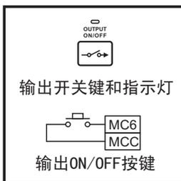
控制器输出受输出开关控制,重复按此键,输出在ON/OFF之间切换。
