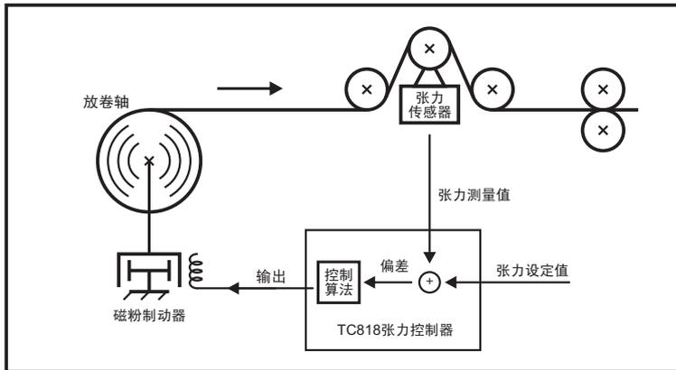
控制器比较张力设定值和张力测量值的偏差，经比例积分微分算法计算后，调节输出，使卷料张力趋于设定值，达到恒张力控制的目的。因此，设置适当的比例，积分，微分和静区参数值对张力系统的稳定性很重要。
