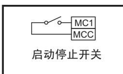
进行自动控制时,请将MC1开关接通。
